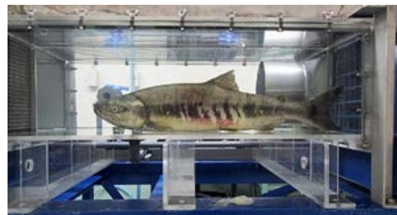
スタミナトンネルに収容したサケ Chum salmon kept in a respirometer.
